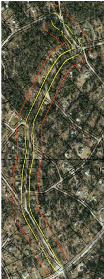
Bullerutbredning från ny bussträckning. Gull linje visar ungefärlig gräns för 55 dBA förutsatt att marken är helt plan och röd linje visar 77dBA under samma förutsättningar.
