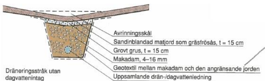
Bild 3. Ett dräneringsstråk i genomskärning (Figur 9.28 i P105).
