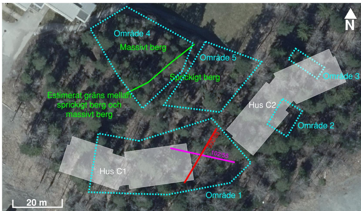
FIGUR 26: ÖVERSIKTSBILD, INKL. ESTIMERAT GRÄNS MELLAN SPRICKIGT BERG OCH MASSIVT BERG.
