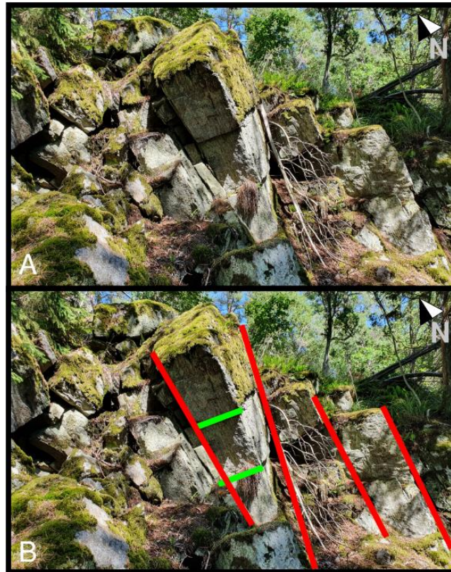
FIGUR 9: (A) FLERA OBSERVATIONER I OMRÅDE 1, (B) MARKERING SPRICKPLAN 1 (RÖD), SPRICKPLAN 2 (GRÖN).
