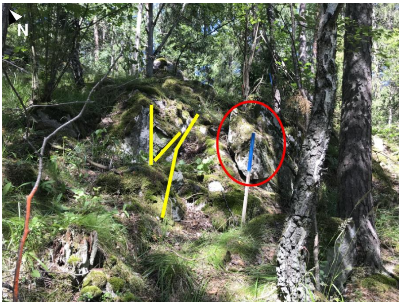
FIGUR 12: ÖVERSIKT OMRÅDE 2, INKL. OBSERVERADE SPRICKOR (GUL) OCH EXEMPEL LÖS BLOCK (RÖD RING).
