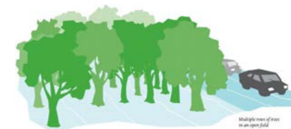
Ett 25 meter brett träd-bälte intill vägarna kan dämpa bullernivån 7 dBA (The HOSANNA project 2013) Illustration: Tove Henix
