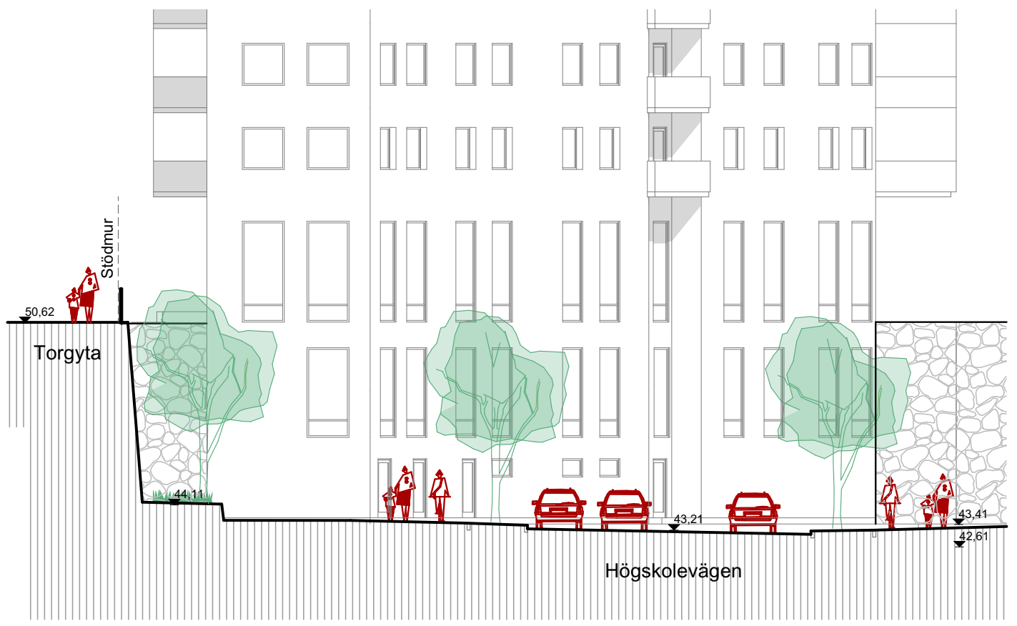
Sektion D-D, muren vid Kv B
