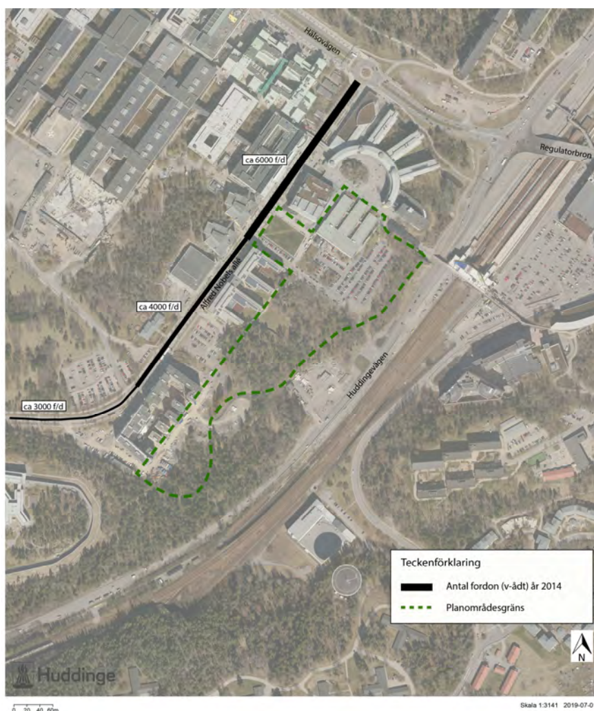
Figur 2-5: Antal fordon per vardagsdygn år 2014 på Alfred Nobels allé. Källa: Huddinge kommun
