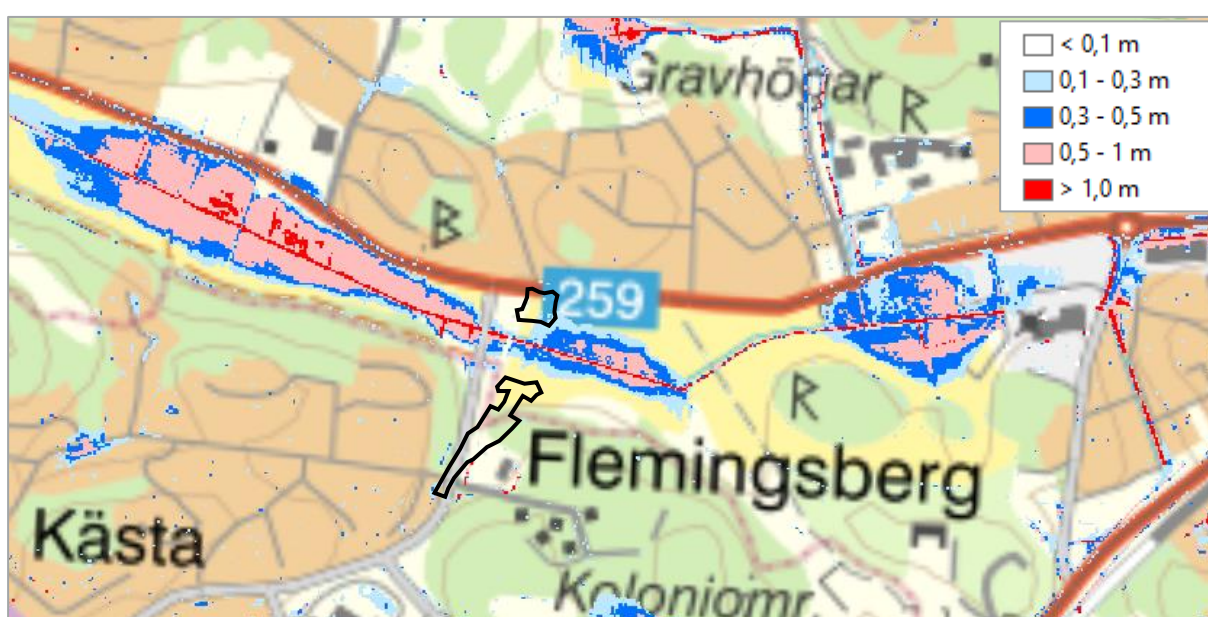
Figur 24. Översvämningsområdet vid ett 100-årsregn med en varaktighet på 6 h enligt Huddinge kommuns skyfallskartering. Skalan visar maxdjup i meter. Källa: Huddinge kommun
