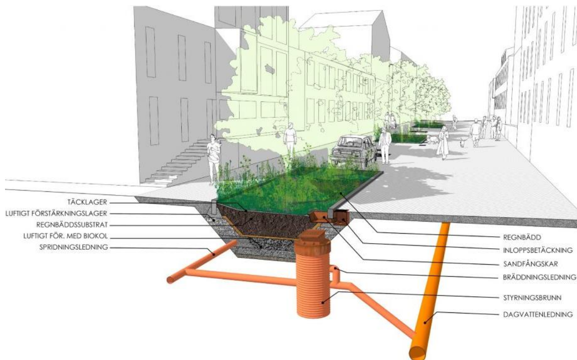
Figur 21. Växtfilterbädd och anslutande hårdgjorda ytor som anläggs med öppet förstärkningslager (ÖF). När växtfilterbädden går full bräddar dagvatten mot styrningsbrunnen som leder dagvatten till ÖF för flödesutjämning. När det är full bräddar dagvatten ut till ledningsnätet via en bräddbrunn med flödesregulator. 17
