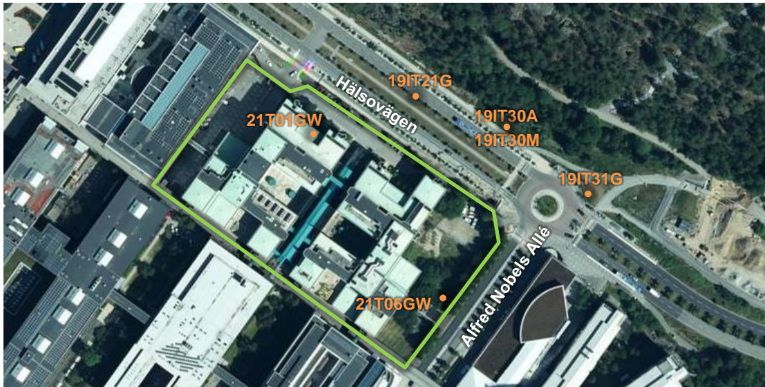
Figur 6. Befintliga grundvattenrör. Grundvattenrör benämnda 21TXXGW har installerats av Tyréns. Övriga rör är inventerade.
