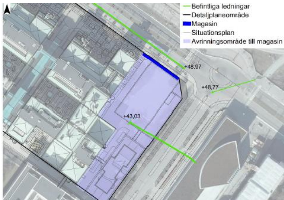
Figur 25. Förslag placering av underjordiskt magasin för flödesutjämning och omhändertagande av skyfall.
