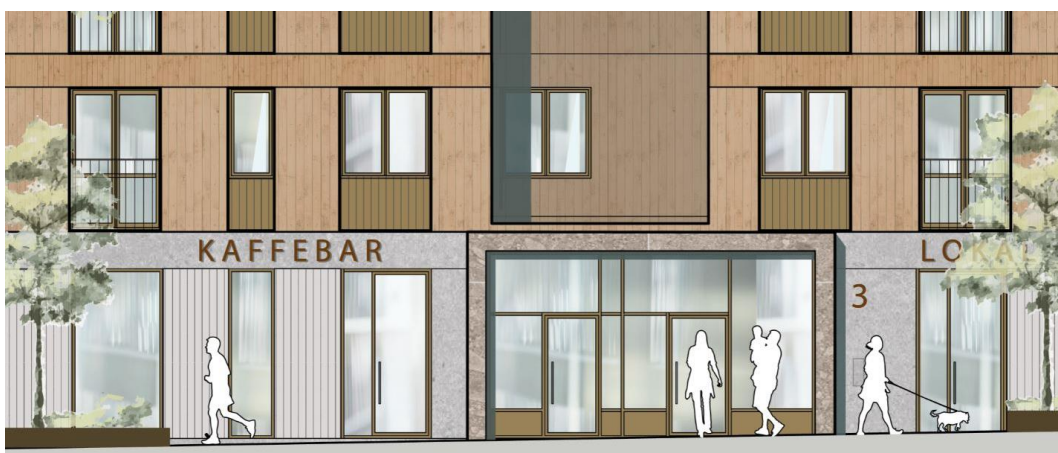
Figur 08. Vision som visar hur sockelväning i bearbetad betong eller natursten kan utformas liksom dess möte med träfasaden. Entréer ska ges en omsorg i utformningen. Bild: Semrén+Månsson
