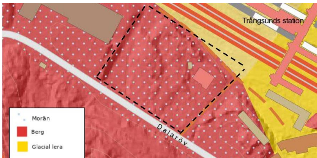
Figur 18. Jordartskarta för planområdet enligt Sveriges geologiska undersökning (SGU). Området består av lera (gult) och berg (rött) med tunt osammanhängande moränlager (ljusblå prickar). Bild: Tyréns/SGU
