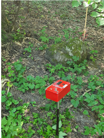
Foton av pågående mätning av markradon, mätinstrument Markus 10.
