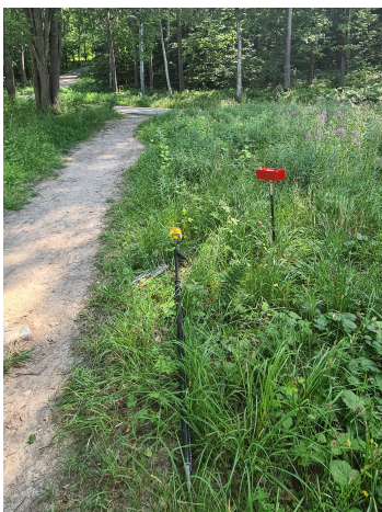
Foton av pågående mätning av markradon, mätinstrument Markus 10.
