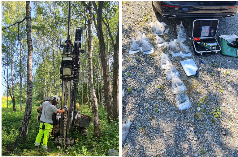
Foto borrhning mha Geotech borrhandsvagn samt mätning av VOC mha PID
