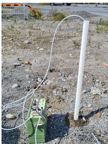
Foton visar uttag av vattenprover mha peristaltisk pump.
