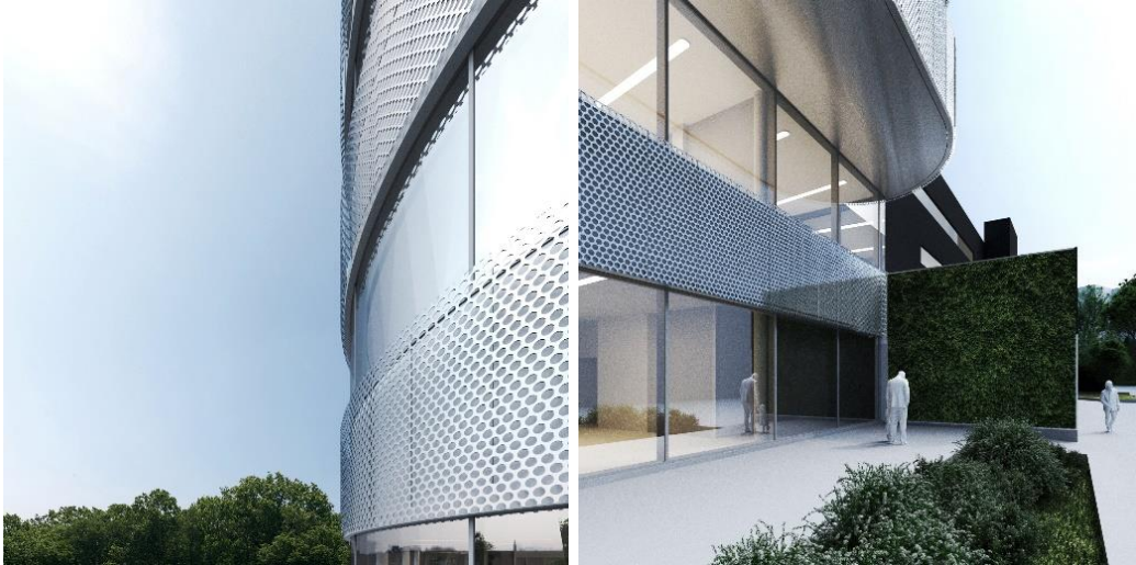
Fasad med perforerad plåt. Bild: Tham & Videgård
