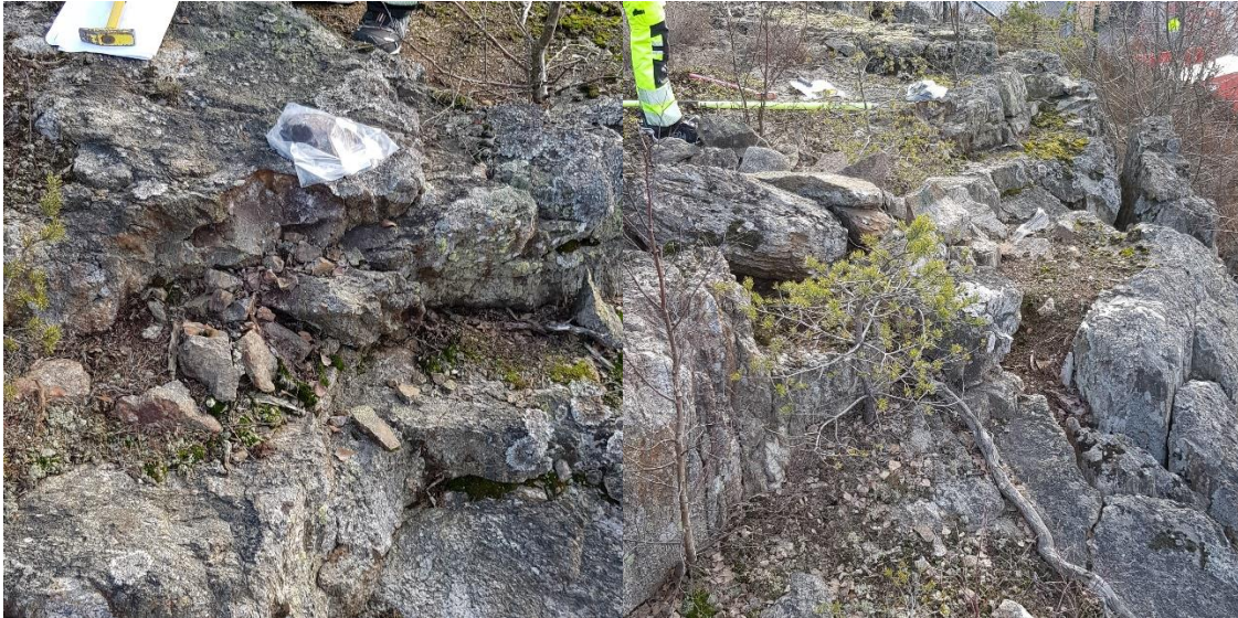
Figur C.1 Fotografi över provpunkt 1 visande vittrad gnejs och en uppsprucken bergmassa.
