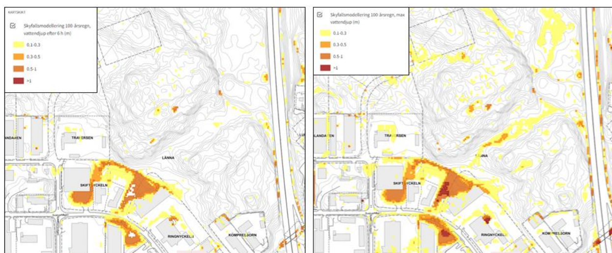
Figur 7. Befintlig skyfallssituation inom aktuellt planområde enligt kommunens övergripande skyfallsanalys (WSP, 2018). Figuren visar vattendjup sex timmar efter ett 100-årsregn till vänster och maximalt vattendjup vid ett 100-årsregn till höger.
