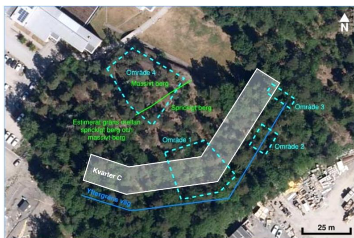
Figur 6. Översiktsskild över inspektionsområde (Figur 2, 2020, Scandinavian Tunneling and Civil Engineering).
