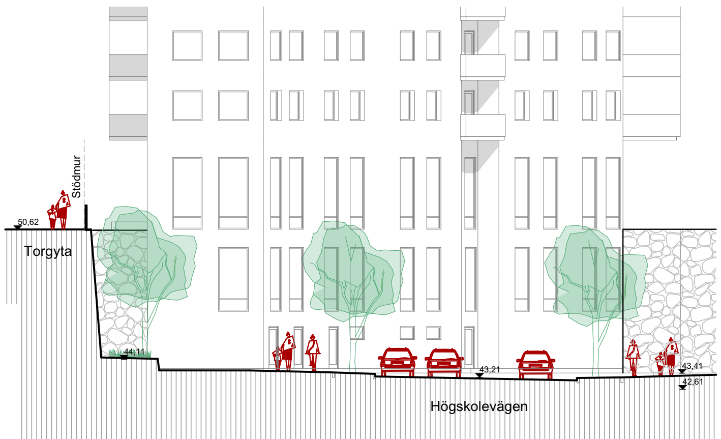
Sektion D-D, muren vid Kv B
