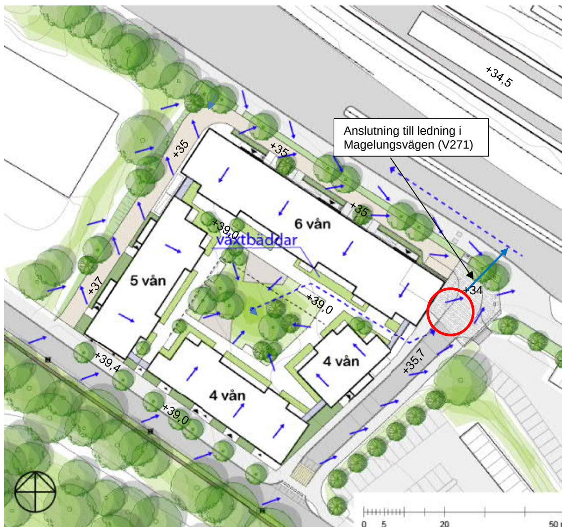
Figur 6. Principlösningar LOD för utredningsområdet. Anslutning mot allmän ledning bedöms kunna ske ut till ledning i Magelungsvägen i höjd med markerad röd cirkeln. Ljusblå pilar utritade för att visa den ungefärliga flödesriktningen inom området.
