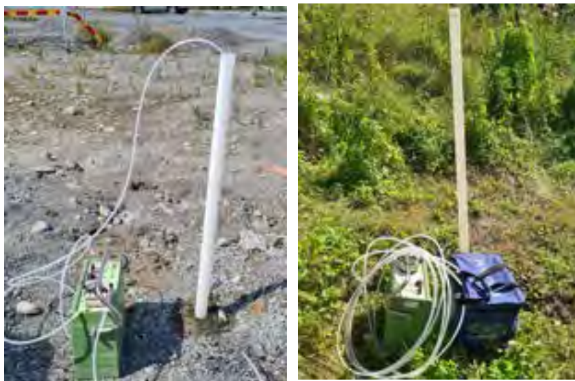
Foton visar uttag av vattenprover mha peristaltisk pump.
