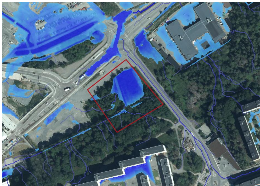
Figur 5. Lågpunkt med redovisad skyfallsansamlingar för 100-årsregn. Ungefärligt planområde i rött. (Scalgo, Huddinge kommun, 2021).
