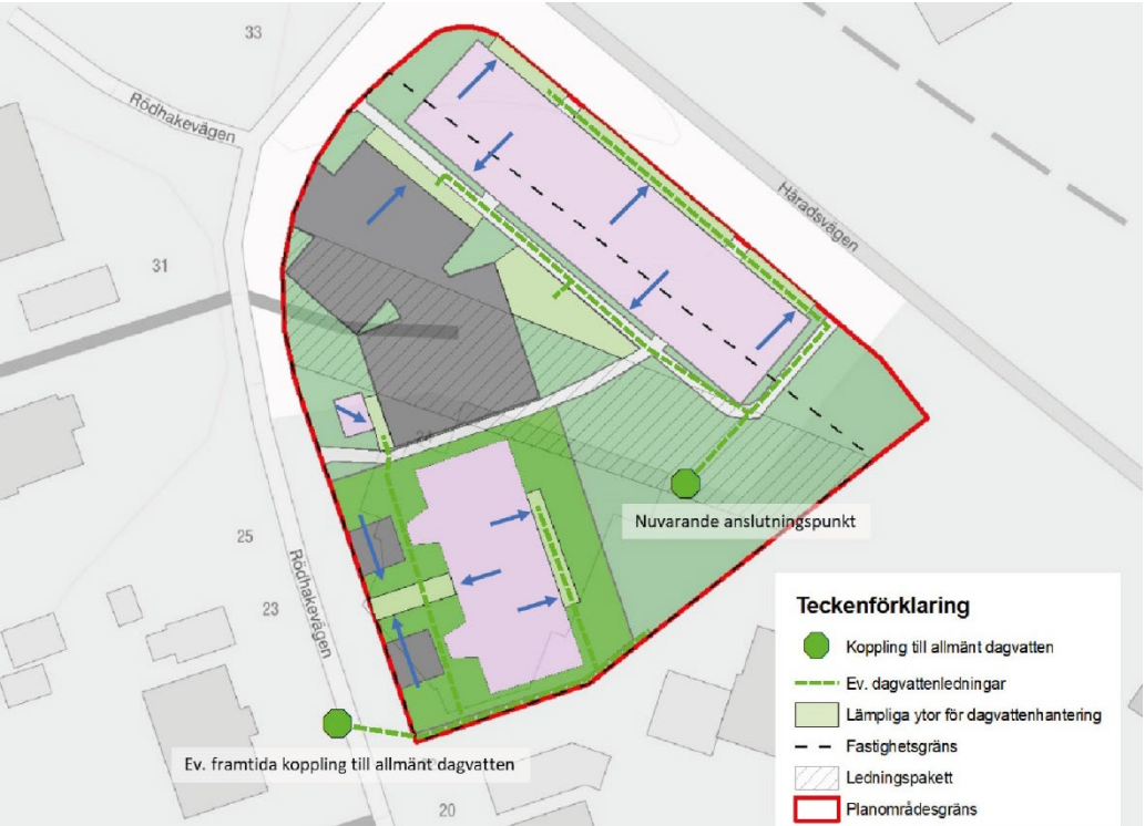
Figur 20. Identifierade lämpliga ytor för dagvattenhantering samt förslag för eventuella dagvattenledningar och anslutning till allmän dagvattenledning. Blå pilar visar avvattningsriktning (Dagvattenutredning, 2024).
