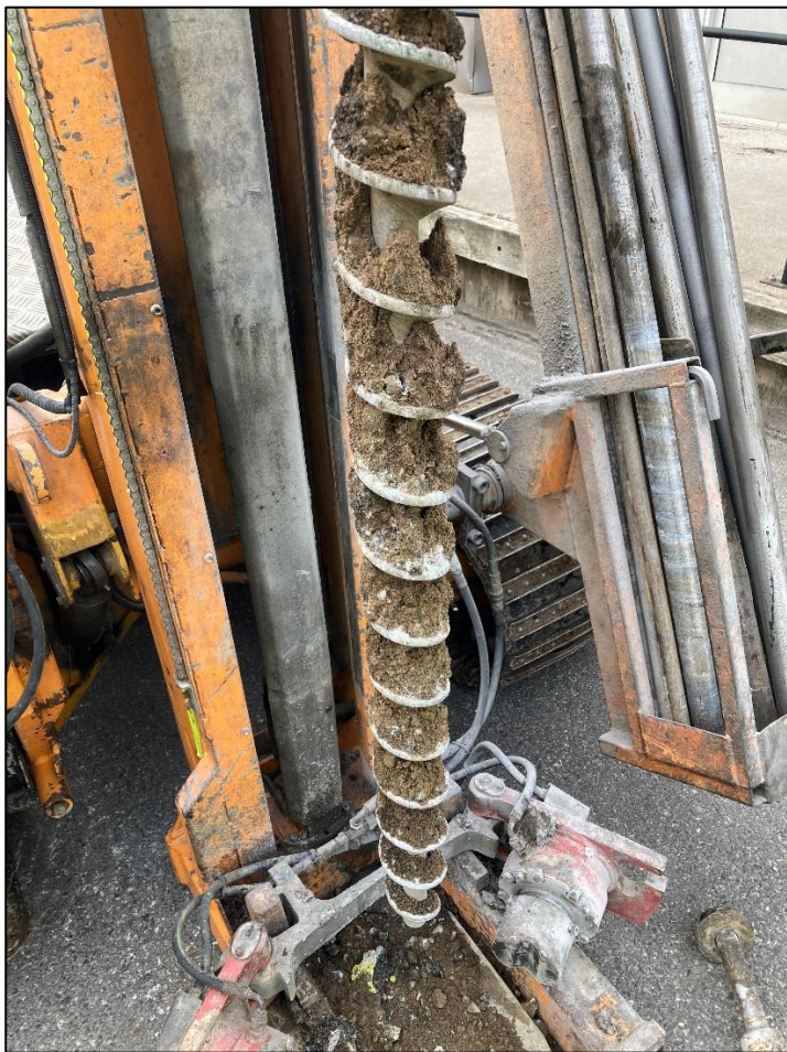
Figur 5-1. Jordskruv från provtagningspunkt 22GS02 0-1 m under markytan. Fyllningsmaterial med grus och sand.
