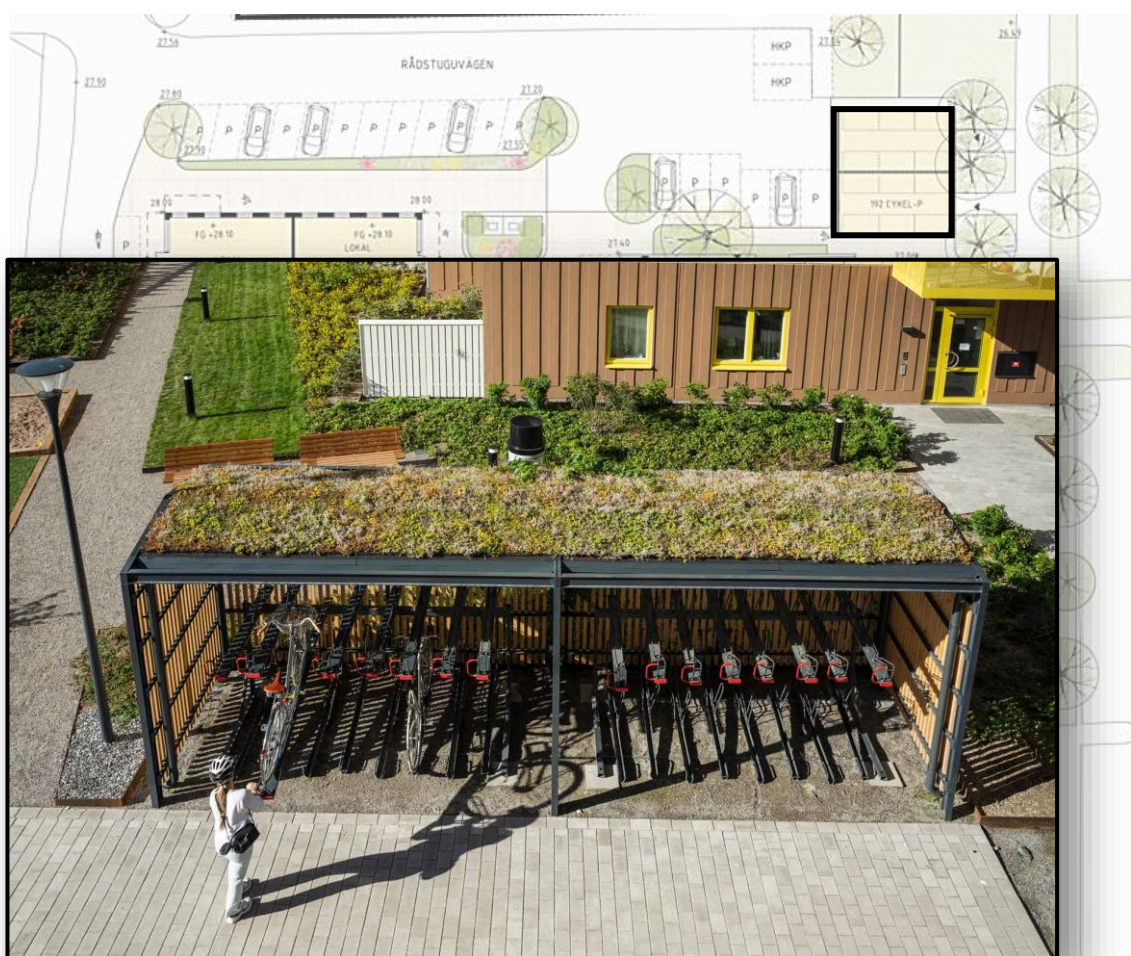
Figur 8. Exempelbild på cykelparkeringshus med träribbor, integrerad LED-belysning och sedumtak.
