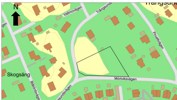
Figur 3.8. Markens genomsläpplighet inom planområdet. Gröna ytor markerar områden med låg genomsläpplighet och gula ytor markerar områden med medelhög genomsläpplighet. Planområdet är markerat med svart polygon (Källa: SGU)
