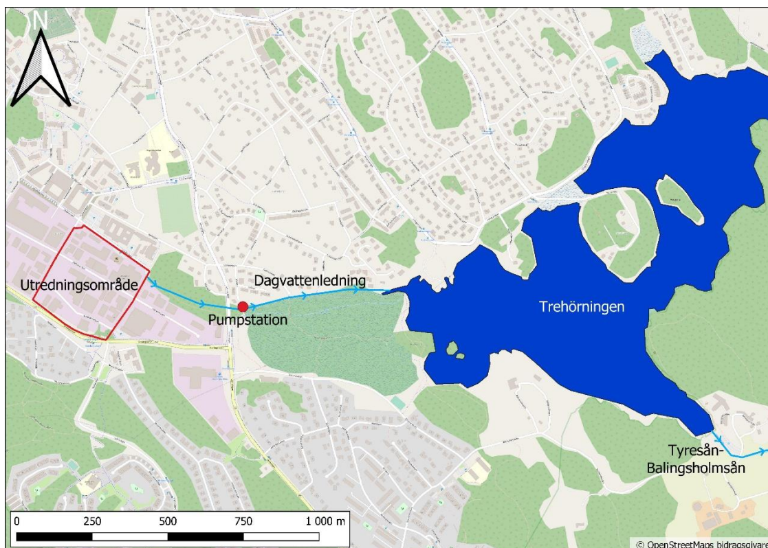
Figur 15. Ytvattenrecipienten Trehörningen öster om utredningsområdet, samt ungefärlig placering av dagvattenledningen och pumpstationen som avleder vatten från området till recipienten. Trehörningen är en del av Tyresån-Balingsholmsåns vattenförekomst. Bakgrundskarta: © OpenStreetMaps bidragsgivare, u.å.
