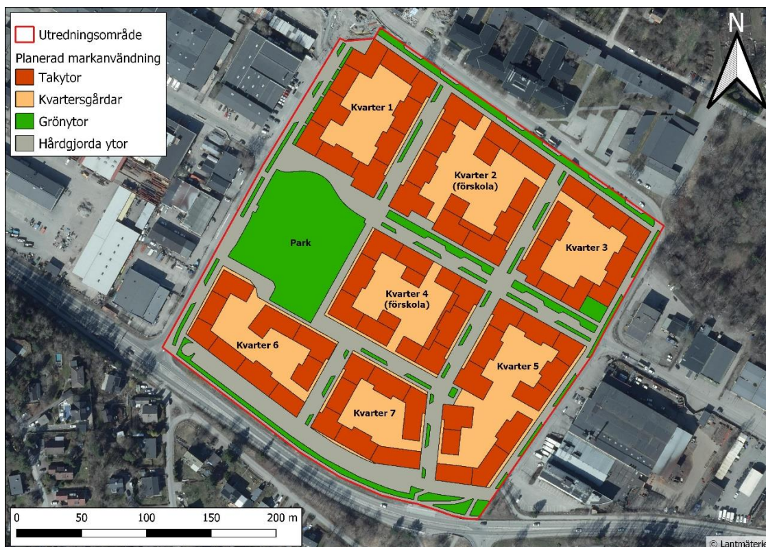
Figur 16. Planerad markanvändning efter exploatering med sju kvarter, varav två kommer att ha förskolor. Ortofoto© Lantmäteriet, u.å.
