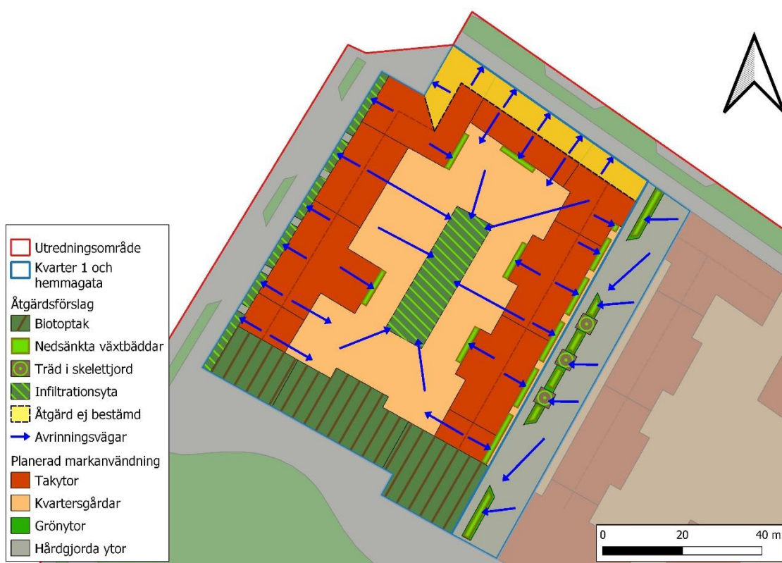
Figur 18. Åtgärdsförslag för kvarter 1, där innergården ligger på bjälklag, samt åtgärdsförslag för hemmagatan mellan kvarter 1 och 2. Kvarter 1: Dagvatten från taken närmast parken utformas som biotoptak. Åtgärd är inte bestämd för takytor mot Sjödalsvägen. Övriga takytor avrinner till nedsänkta växtbäddar och infiltrationsytor på innergård och förgårdsmark. Hemmagatan: Dagvatten från gatan avrinner till nedsänkta växtbäddar och träd i skelettjord placerade inom gränserna för grönytor.
