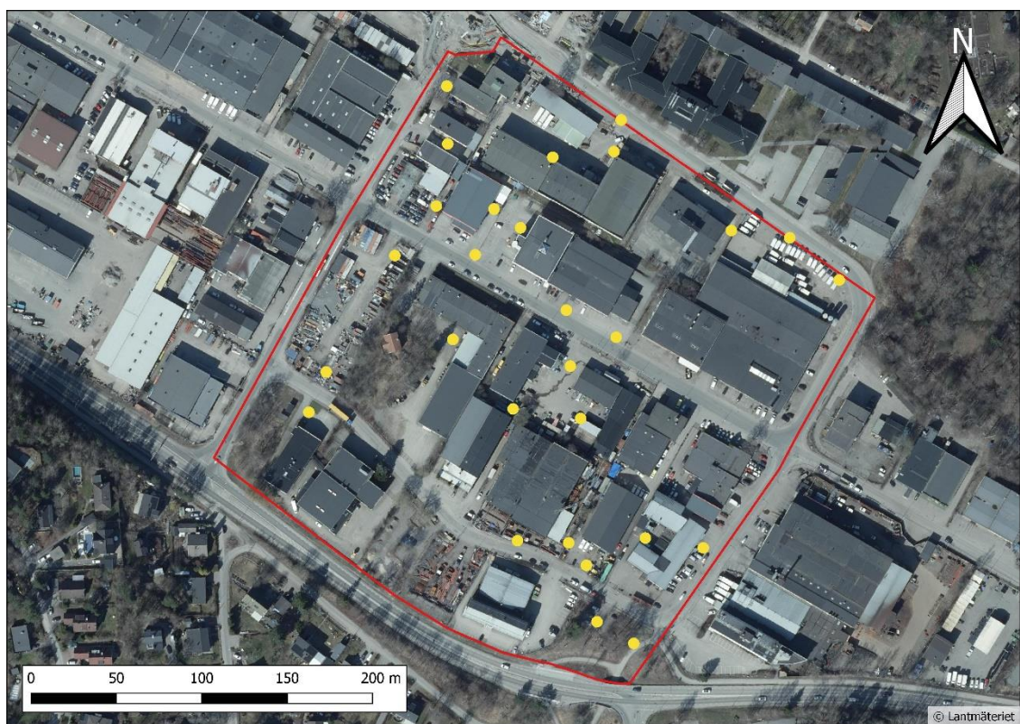
Figur 10. Ungefärlig placering av provtagningspunkter för mark där en eller flera föroreningar överskrider riktvärdena för känslig markanvändning (KM) enligt miljöteknisk markundersökning (WSP, 2021). Ortofoto: © Lantmäteriet, u.å.
