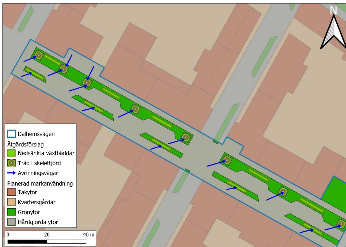
Figur 23. Åtgärdsförslag för Dalhemsvägen. Dagvatten avrinner från gatan till växtbäddar och träd i skelettjord. Placering av anläggningar och avrinningsvägar är ett exempel utifrån hur grönyterna är planerade i den preliminära illustrationsplanen, men kan ändras efter behov.
