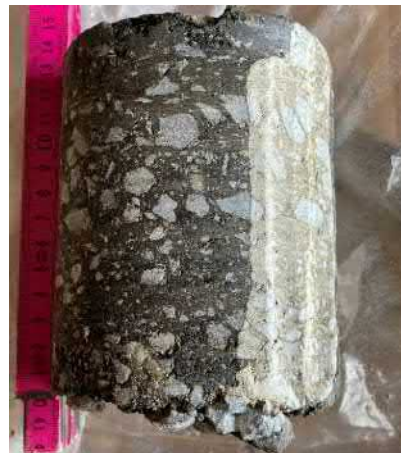
Bild 4. Asfaltkärna från provpunkt 21G52
