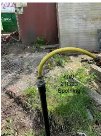
Bild 11. Spolning av grundvattenrör 21G23
