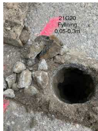
Bild 12. Skruvprov provpunkt 21G20
