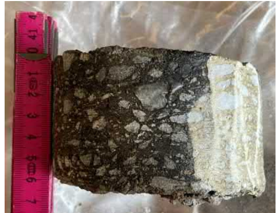
Bild 2. Asfaltkärna från provpunkt 21G19
