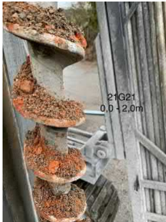
Bild 13. Skruvprov provpunkt 21G21
