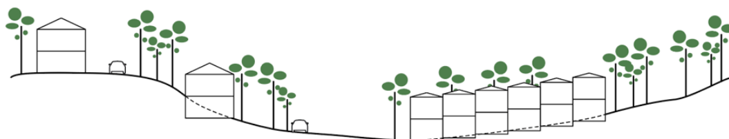
Figur 5. Bilden visar princip för terräng- och naturanpassning av fristående hus och rad-, kedje- och parhus.
