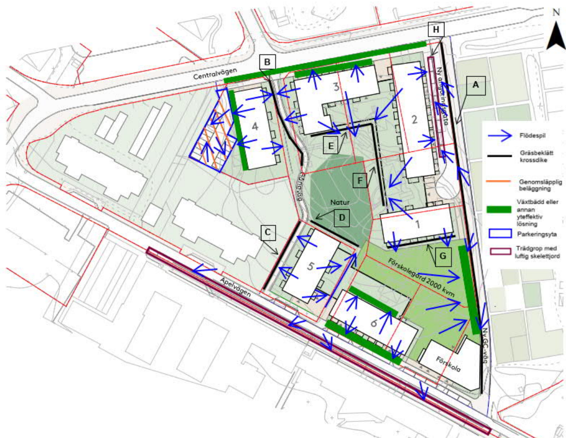
Figur 9. LOD-lösningar för olika delområden. Principskiss som visar avvattning av tak och främst hårdgjorda markytor mot föreslagna LOD- åtgärder inom planområdet. Förskolans tak anläggs med gröna tak.
