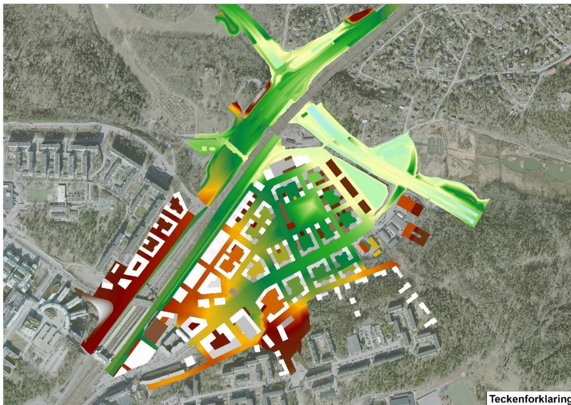
Figur 1: De områden som ersätts med nya höjder från den nya strukturplanen Flemingsbergsdalen och TSÖ. Därtill ingår hela väganläggningen i Glömstadalen (visas ej på bilden). Färgerna visar framtida höjd av mark och byggnader.
