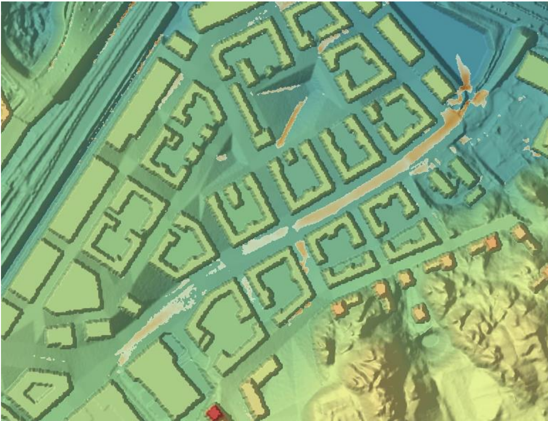
Figur 23: Figuren visar områden med maximal flödes hastighet över 1 m/s – markerad med orange. Åtgärder i Visättra förutsätts vara anlagda.
