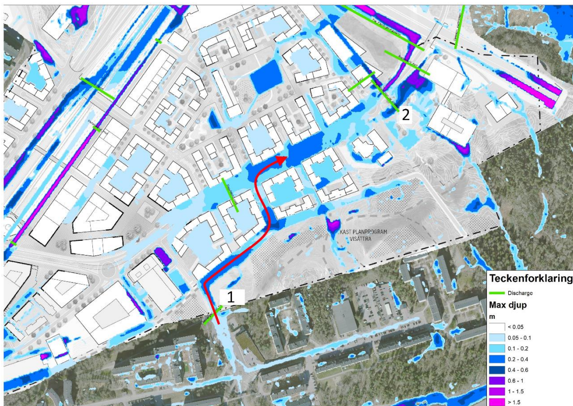
Figur 14: Maximalt vattendjup (m) för scenariot utan åtgärder i Visättra (worst case) och utan skyfallsfördröjning i stadsdelsparken och översvämningssytan vid TSÖ. Skyfallsled markeras i rött. Flödet är mätt vid punkterna 1 och 2. Observera att vid punkt 2 har byggnaderna ritats om något efter modelleringen, vilket gör att det ser ut som att vattnet rinner genom byggnaden, medan det egentligen rinner strax norr om byggnaderna.
