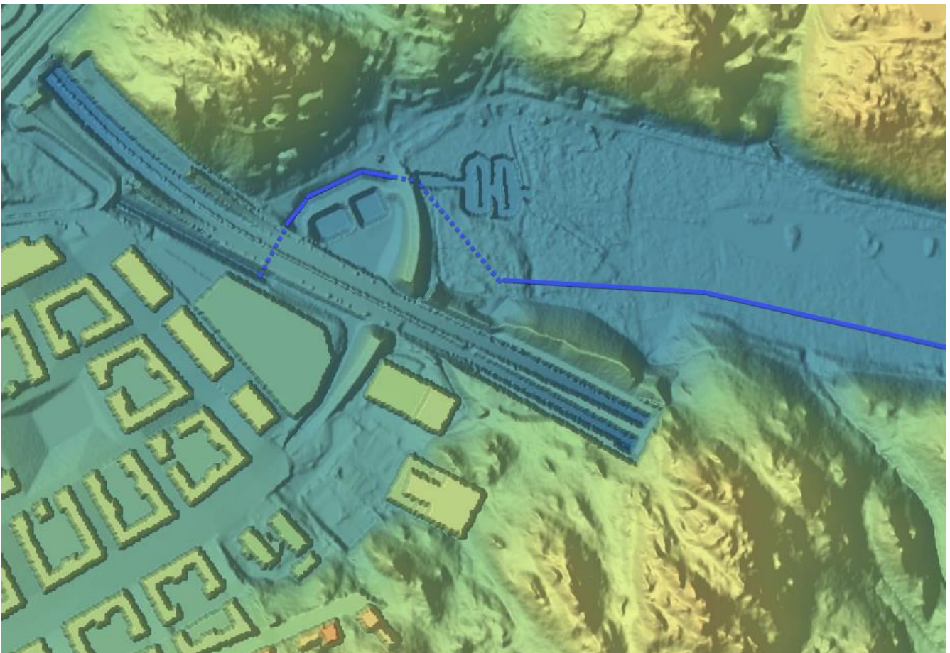
Figur 17: Placering av kulvertar (streckad blå linje) och öppna diken (heldragen blå linje) som modellerats.
