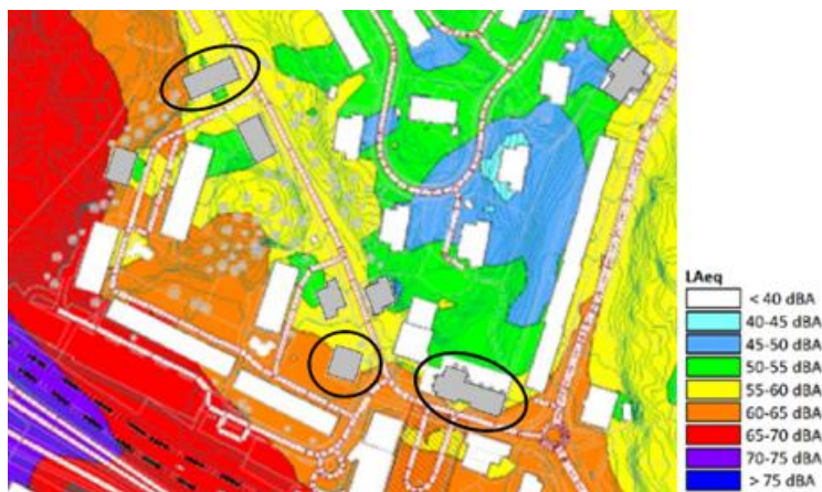
Figur 10. Ljudutbredningskarta 15 meter över mark (Delta Akustik, 2024). Markerade byggnader är de som kräver bullerreducerande balkonger för att samtliga lägenheter ska uppnå trafikbullerförfordningens riktvärden.
