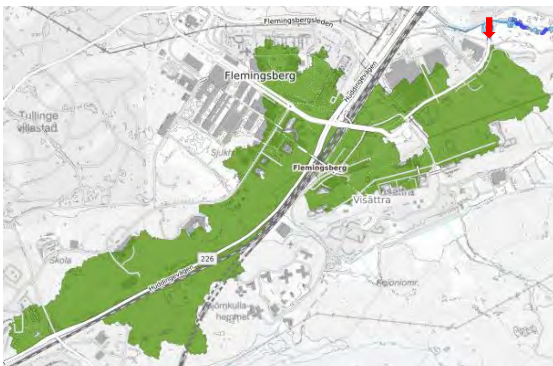
Figur 3-2. Det ytliga avrinningsområdet för befintlig situation för ett 60 mm-regn, för punkten där det tänkta utloppet från programområdet kommer vara (röd pil). Analys gjord i Scalgo live, 2020-01-30.
