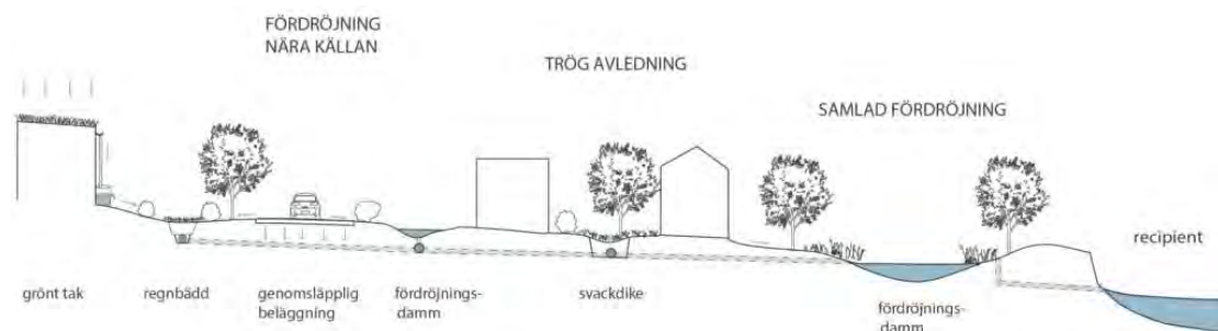
Figur 5-1. Principillustration av dagvattnets avrinning med hantering nära källan och fördröjning i flera steg på vattnets väg mot recipienten. Illustration: Anna Lyth och Elise Eriksson efter skiss från Svenskt Vatten.
