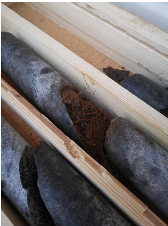
Bild 3: Slag i BH5 inblandning av lera och växtlighet.
