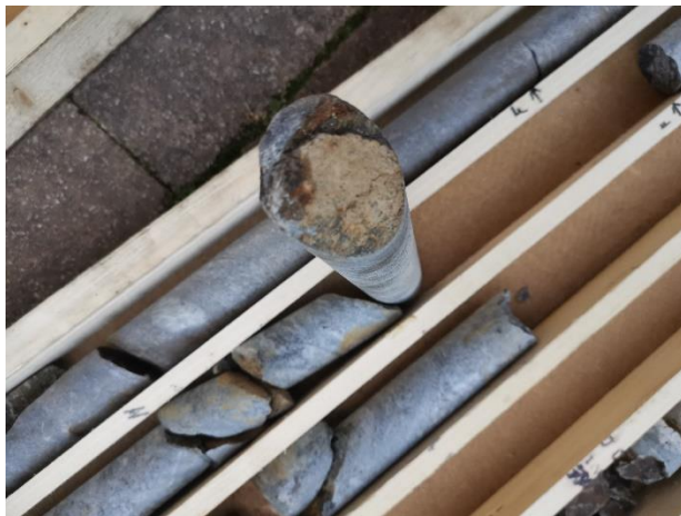
Bild 1: Oxiderad kärna från BH 1 Syd
