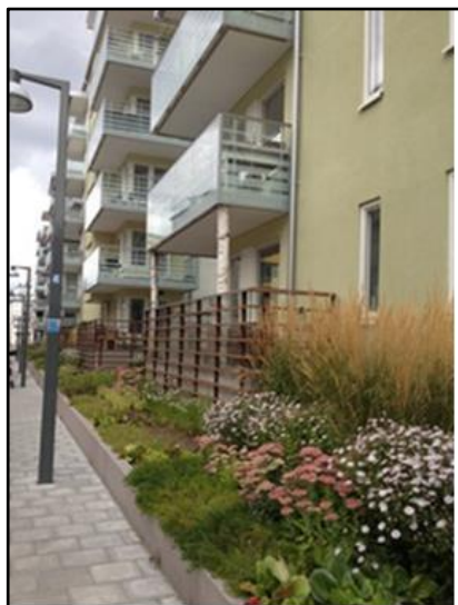
Figur 14. Växtbäddar på innergård för avvattning av exempelvis dagvatten från takytor.
