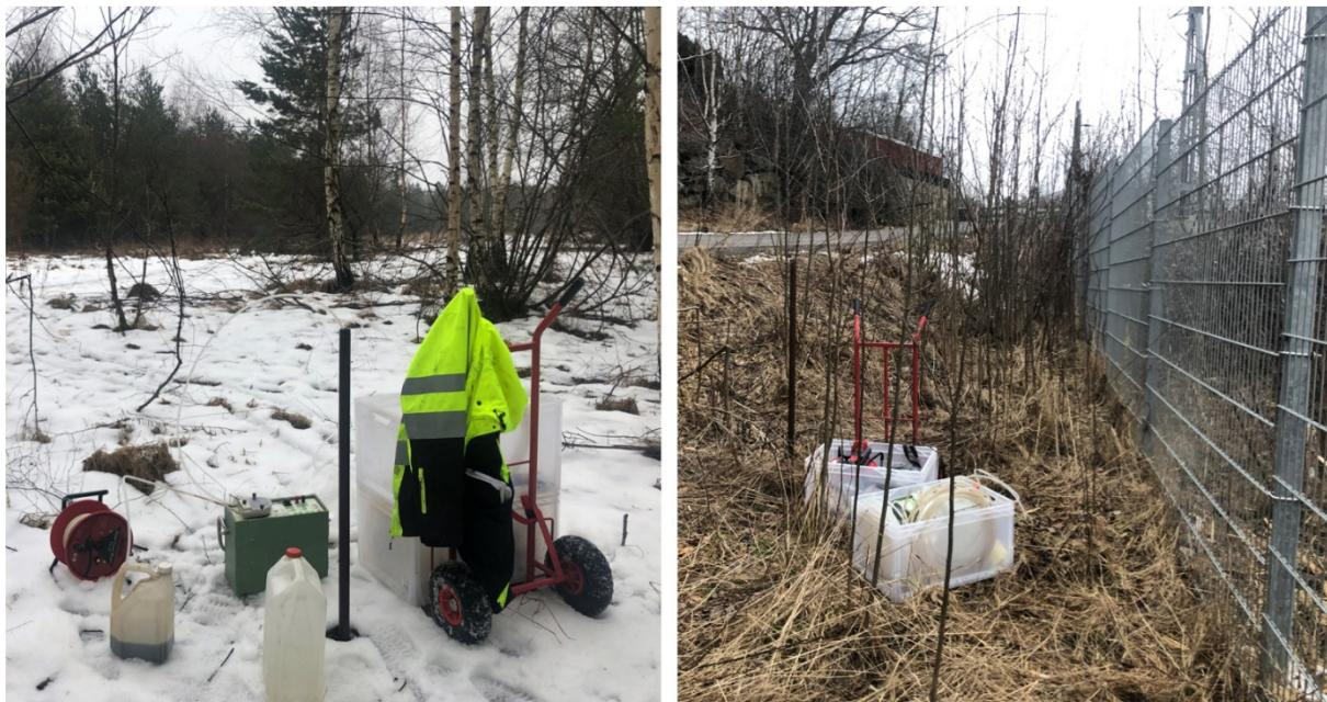
Figur 1 Installation av mätpunkter och pågående provtagning av porluft på kolrör
