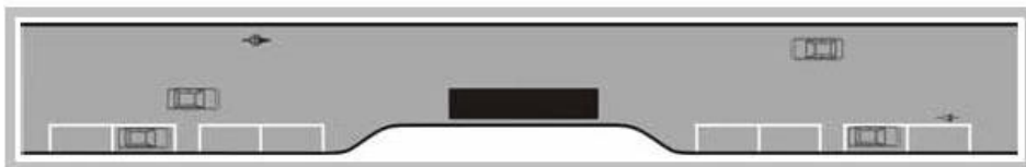
Exempel på hur en klackhållplats kan vara utformad.
