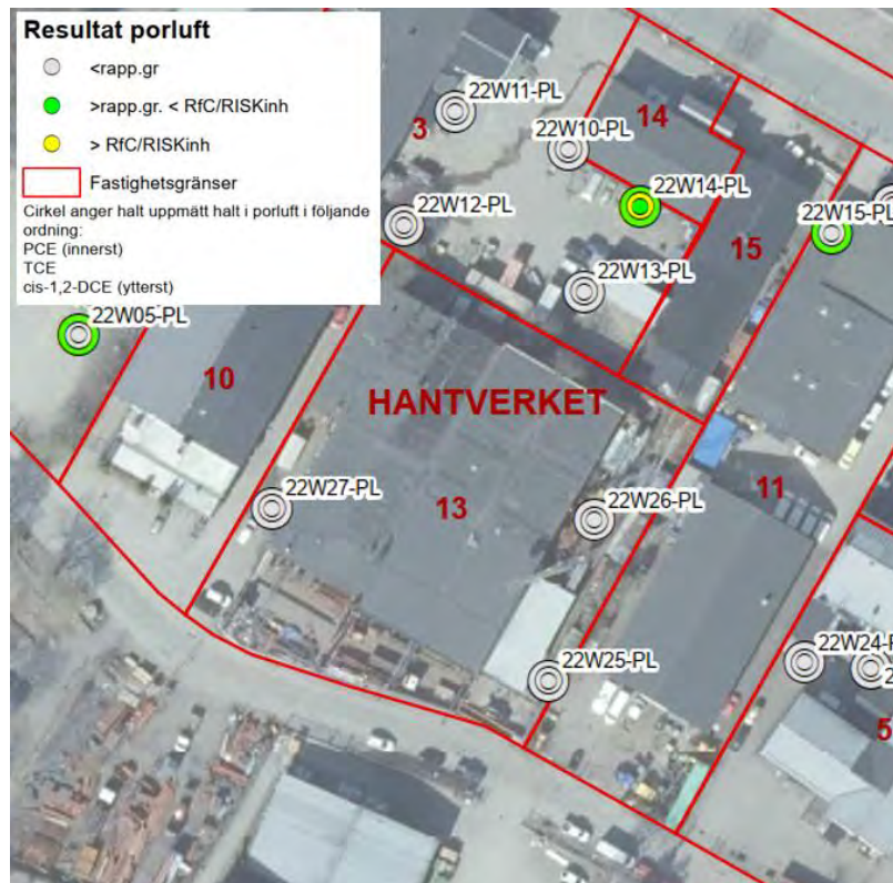
Figur 11. Utklipp över provtagningspunkter i porluft från den kompletterande provtagningen 2022 (WSP, 2022b).
