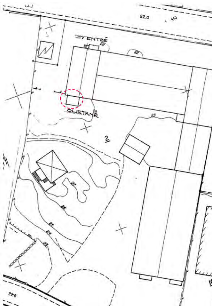
Figur 11. Inbyggnad av oljetank 1997, se röd markering. Källa Huddinge kommuns bygglovsarkiv. [besökt 2022-11-01].
