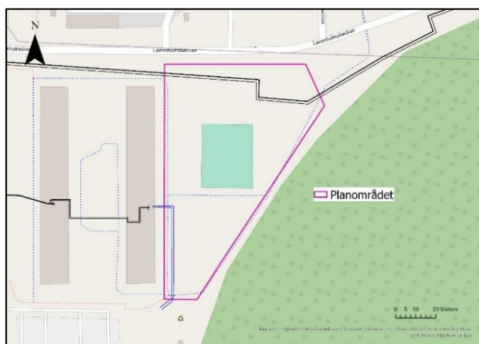
Figur 7. Befintliga fjärrvärme och el ledningar. Bildkälla: bearbetat underlag från Ledningskollen i ArcGIS Pro.
