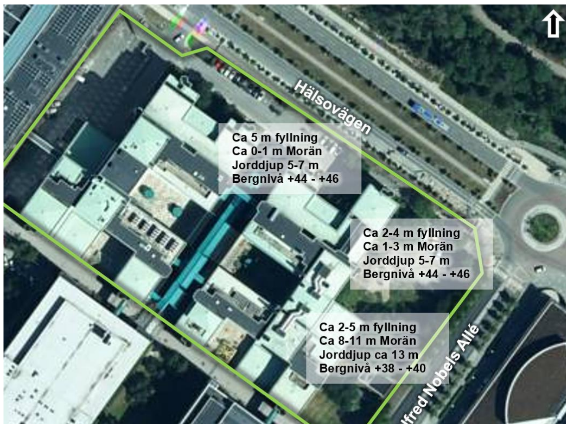
Figur 5. Resultat från geoteknisk undersökning genomförd av Tyréns 2022. 9
