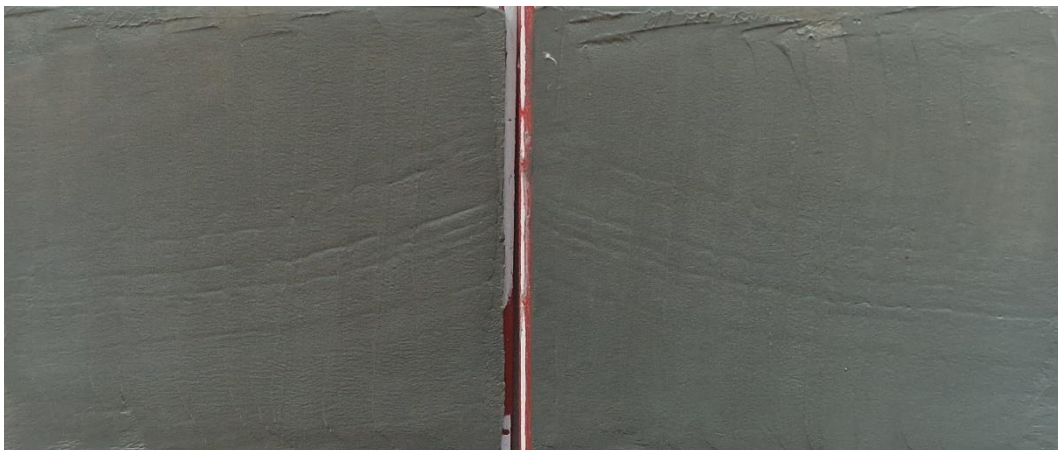
Figur 3 Borrpunkten, 23B03, 8,5 m, Jordprovet i nedre delen av mellanhylsan delad longitudinellt provhylsan med id Bjerking 1030.
