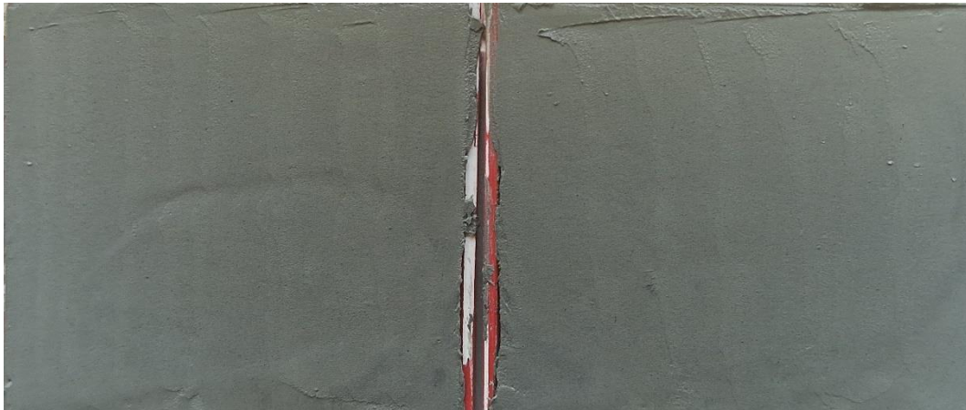
Figur 1 Borrpunkten, 23B03, 2,5 m, Jordprovet i nedre delen av mellanhylsan delad longitudinellt provhylsan med id Bjerking 1112.
