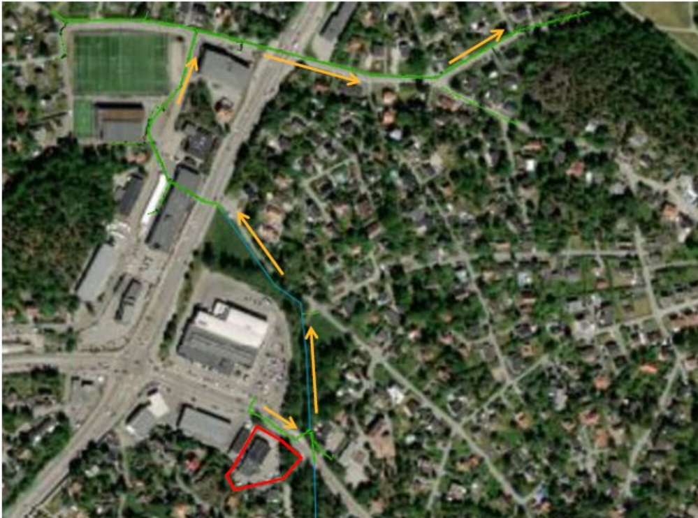
Figur 7. Fagerängsdiket och befintliga dagvattenledningar samt kulvert som leder bort dagvatten från planområdet till Kräppladiket. Gröna linjer avser befintliga dagvattenledningar, blå linjer avser Fagerängsdiket. Planområdet markerat med röd polygon. (Källa, Dagvattenutredning, Structor, 2023)
