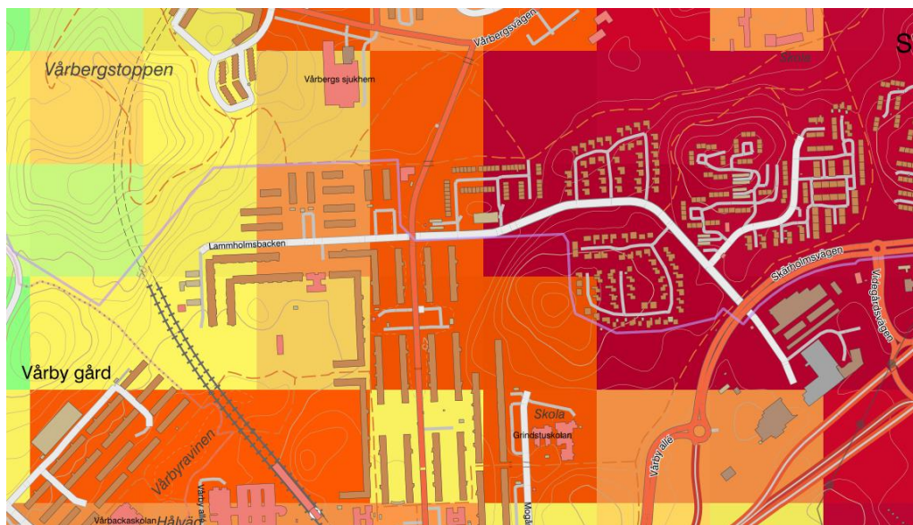
Fig. 1 Urklipp ur SGUs karta som visar gammastrålning för uran (U-238) © Sveriges Geologisk Undersökning
