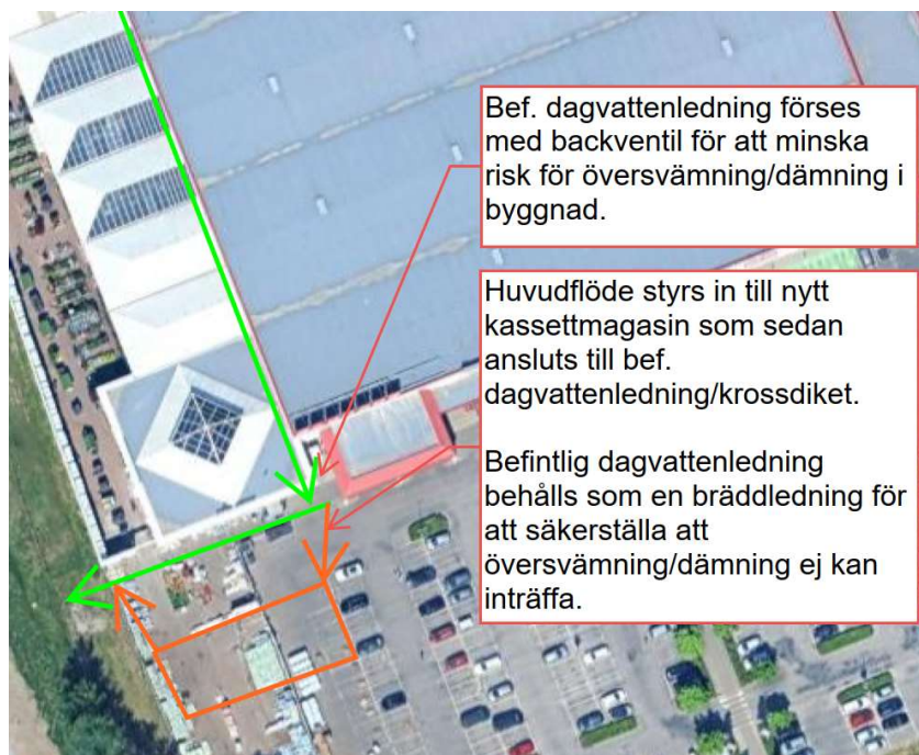
Figur 15. Rekommenderad dagvattenåtgärd för Sågverket 1. Röd markering visar förslag på placering av dagvattenkassetter som grävs ner under mark.
