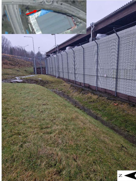
Figur 13. Bild från platsbesöket 2025-01-21. Fotografens placering och riktning på kameran visas m.h.a den röda pilen vänstra hörnet. På fotografiet ses diket beläget strax norr om fastigheten. Diket utgör den naturliga lågpunkten i området.
