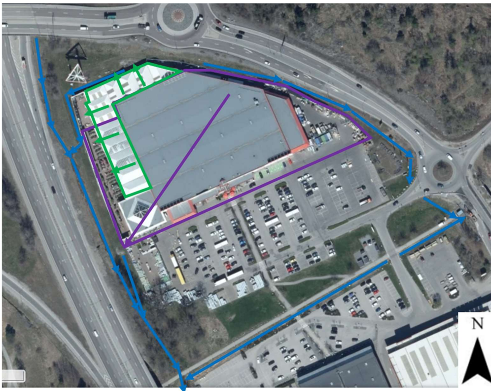
Figur 5. Översikt ytliga avrinningsområden. Blå pilar visar de befintliga diken och flödesriktning. Lila område och lila pil visar befintlig byggnad och delar av parkeringen som avvattnas genom ledningsnät till krossdike i väster. Grönt område och gröna pilar visar befintligt tak som ska byggas om och avvattnas genom ledningsnät och stuprör.
