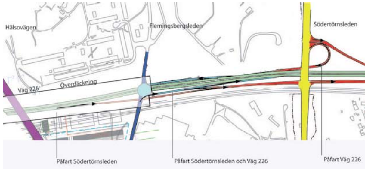
Ramplösning mellan Södertörnsleden och överdäckningen.
