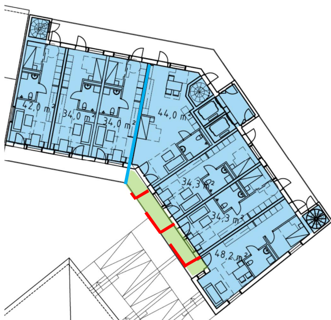
Bild 2 Förslag skärmningsåtgärder, samtliga våningsplan, trp 4, höghuset. Blått streck visar möjlig avdelning av stommen, rött streck visar tät balkongskärm från golv till tak (ex. glasad), grön yta visar absorbent i balkongtak
