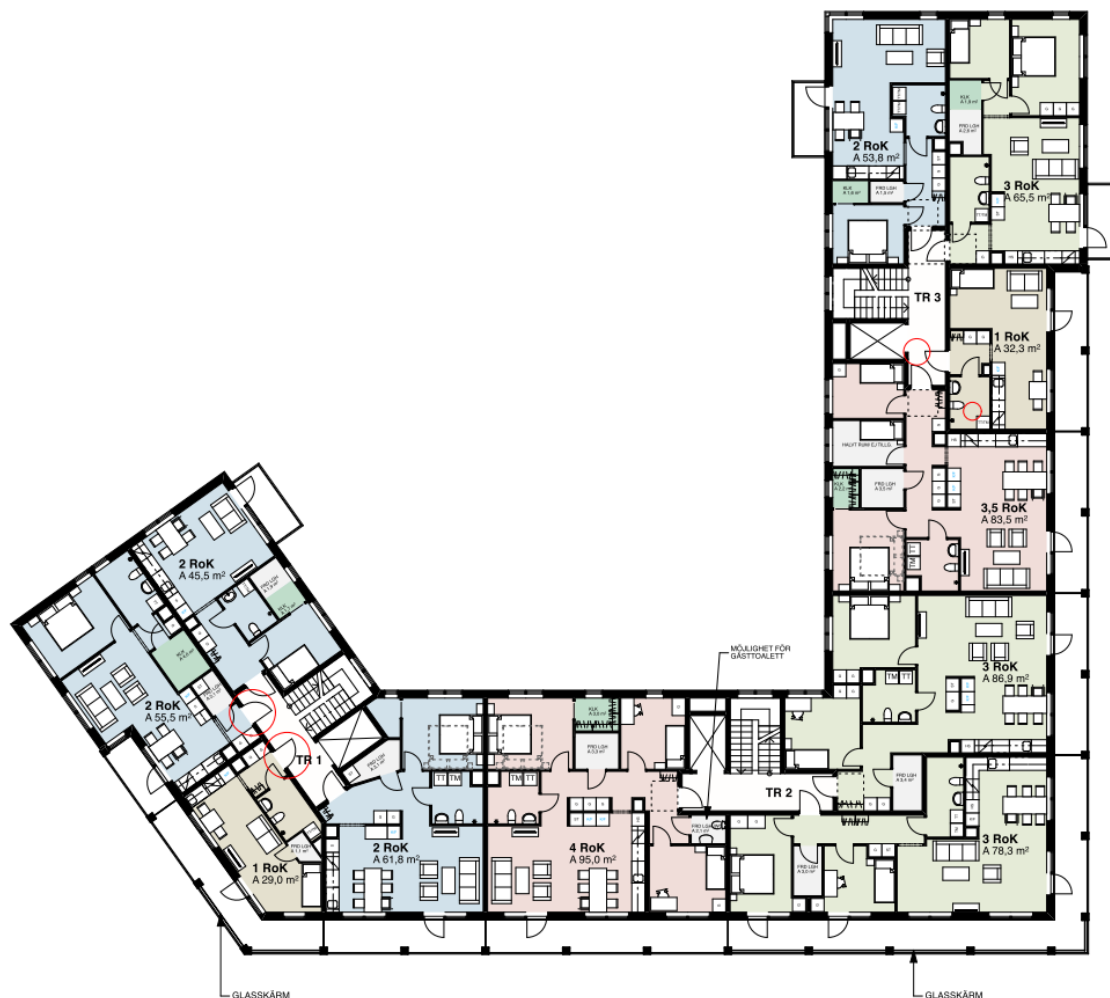
Figur 3. Förslag till ny planlösning. Den mindre lägenheten med loggia är borta och angränsande lägenheter har istället utökats
