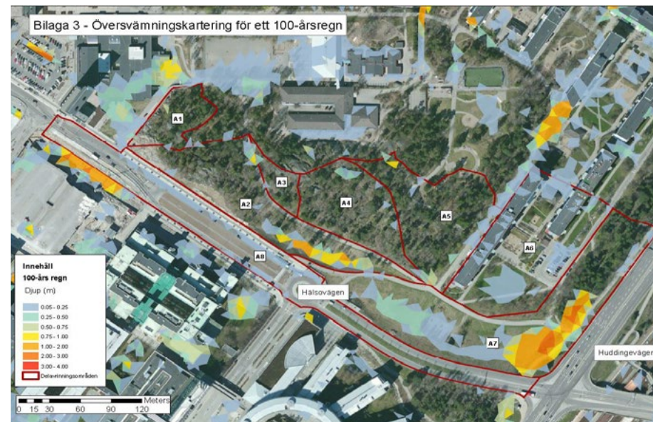
Översvämnning vid 100-årsregn, Dagvattenutredning, Atkins.
