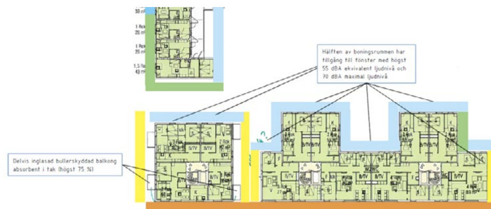
Principiella lägenhetslösningar ut mot Hälsovägen med bullerskyddade balkonger
