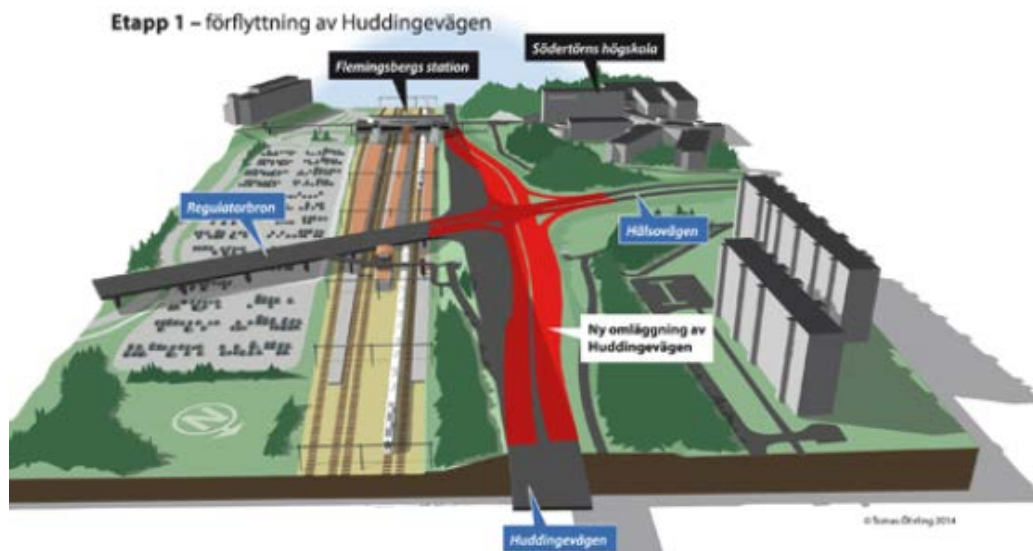
Översiktsbild på väg 226, Huddingevägens, sidoflyttning för tillkommande spår
