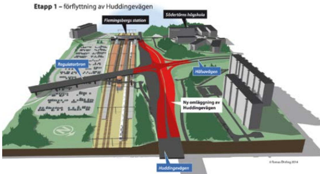
Översiktsbild på väg 226, Huddingevägens, sidoförflyttning för tillkommande spår
