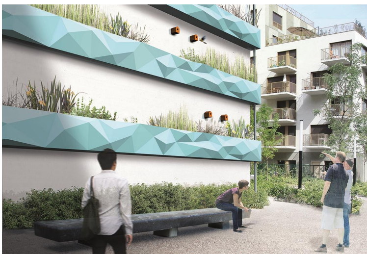
Figur 17. Vertikala regnträdgårdar på fastighetsmark (URBIO).
